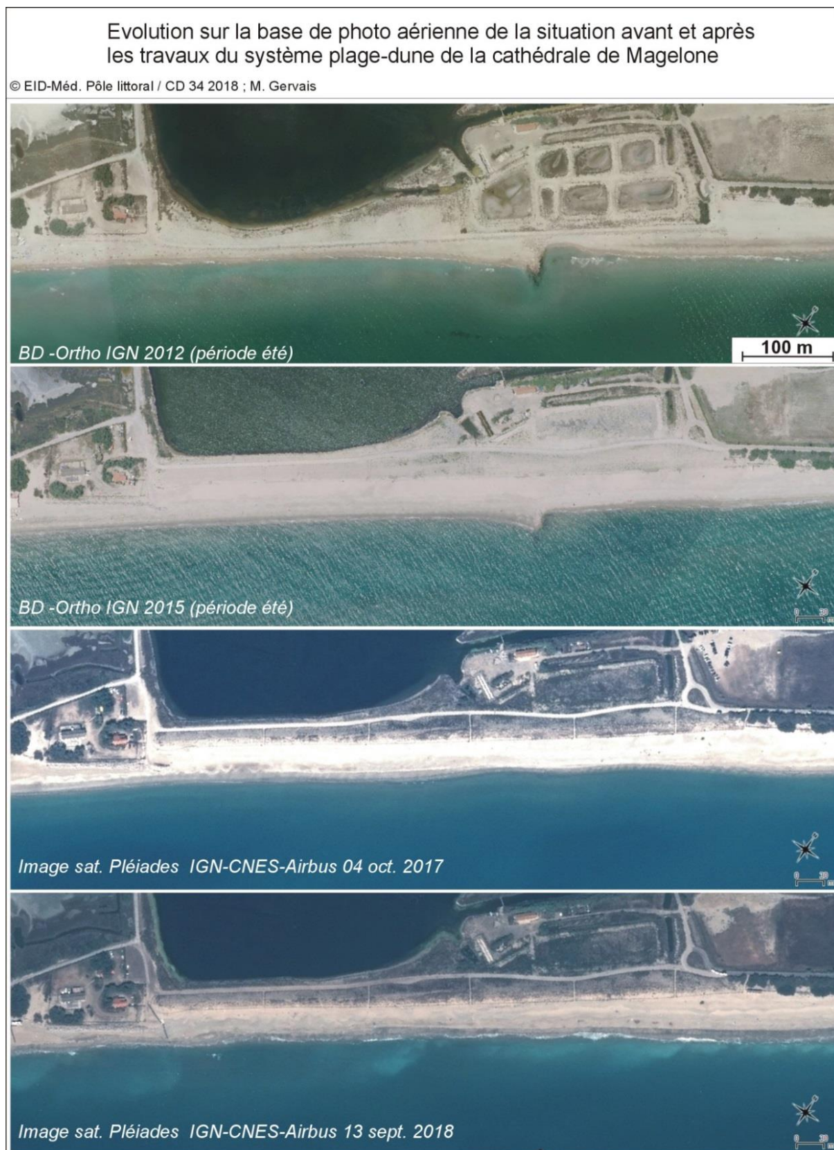
Figure 5 : évolution avant et après travaux du système plage-dune sur le secteur de la cathédrale de Maguelone
