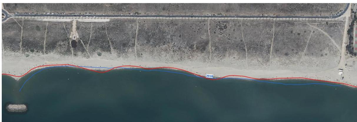
On peut supposer que ce recul récent fait suite à l'installation des derniers brise-lames en 2014 un peu plus au sud. La dynamique progressive du sable au sein des brise-lames est due à un blocage des sédiments dans cette zone et pas à un apport nouveau de sable. Ainsi le sable naturellement déplacé du sud au nord par la dérive littorale est bloqué et n'atteint plus la plage du Mas de l'Isle.
