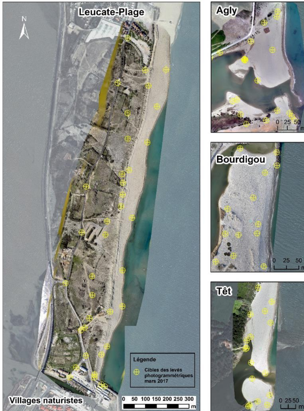
Illustration 6 - Exemple du positionnement des cibles pour les levés photogrammétriques.
