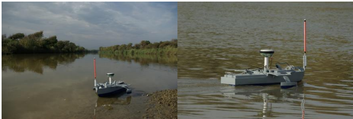
Illustration 8 - Rimouski, drone radiocommandé mis en oeuvre par la société Ecoceanodrone pour l'acquisition bathymétrique des embouchures. Exemple sur l'embouchure de la Têt.
