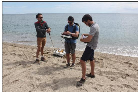
Sur plusieurs profils, cette expertise a permis de révéler la nature et l'épaisseur des sédiments réellement présents sous la surface levée au DGPS et au Lidar (à terre) ou au sondeur (en mer). Les résultats ont mis en évidence un fort stock sableux à terre et en mer. On estime que les sédiments sableux concernent environ 4 mètres d'épaisseur à terre mais le toit de la nappe d'eau saline est détecté très rapidement.
