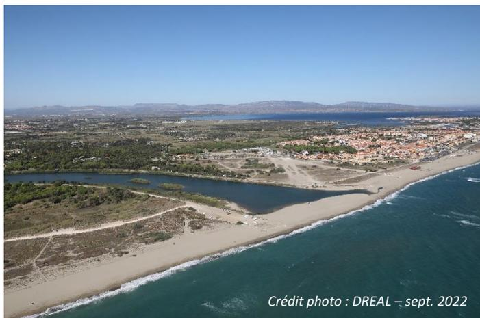
L’embouchure de l’Agly est endiguée par deux d’enrochements situés de part et d’autre des berges afin d’en limiter la mobilité. Entre ces deux enrochements, des flèches d’embouchure (bancs de sable ou « langues » sableuses) se forment au cours des périodes de faible agitation et de débit réduit.
