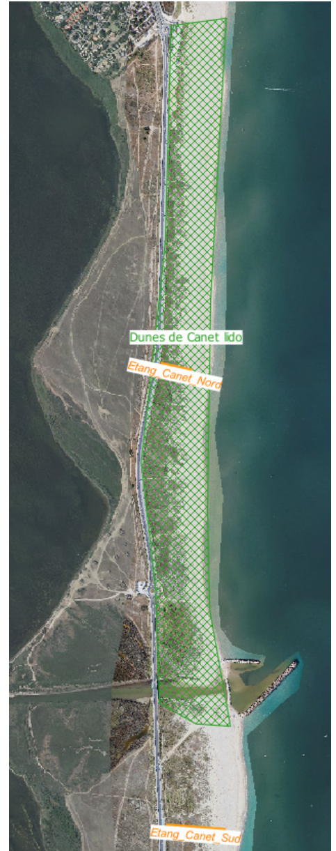
Illustration 107 : Emprise du levé photogrammétrique (en vert) et localisation des transects de végétation sur le lido de Canet (en orange).
