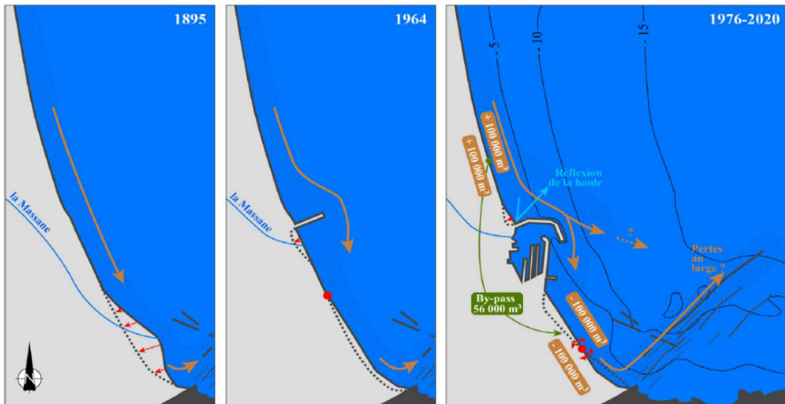
Illustration 57 : Schéma conceptuel du fonctionnement morpho sédimentaire de la plage d’Argelès-sur-Mer et du Racou, Certain et al. (2020).
