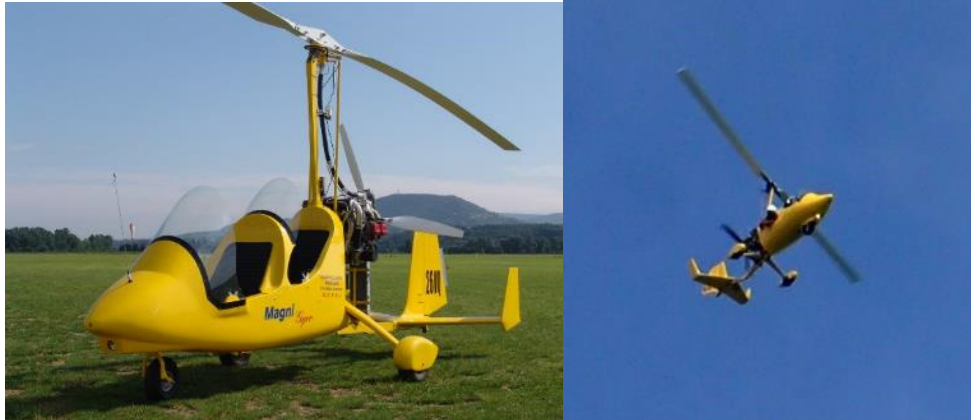
Illustration 9 : Plateforme de vol autogire. À gauche : modèle d'autogire (source wikipédia) similaire à celui utilisé pour les levés post-tempête, à droite photographie de l'appareil en action (source équipe terrain Obscat 2017).
