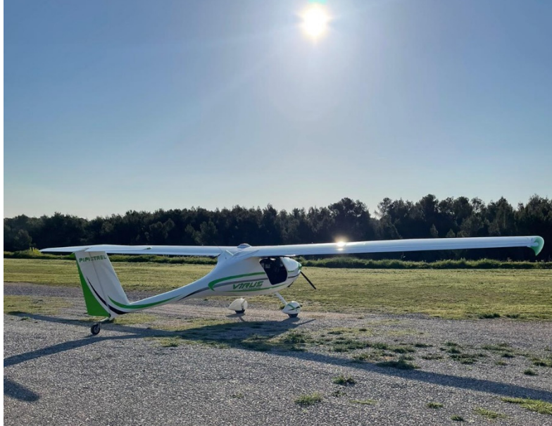
Illustration 35 : ULM Virus Pipistrel utilisé pour la mission LiDAR du 26/04/2022.
