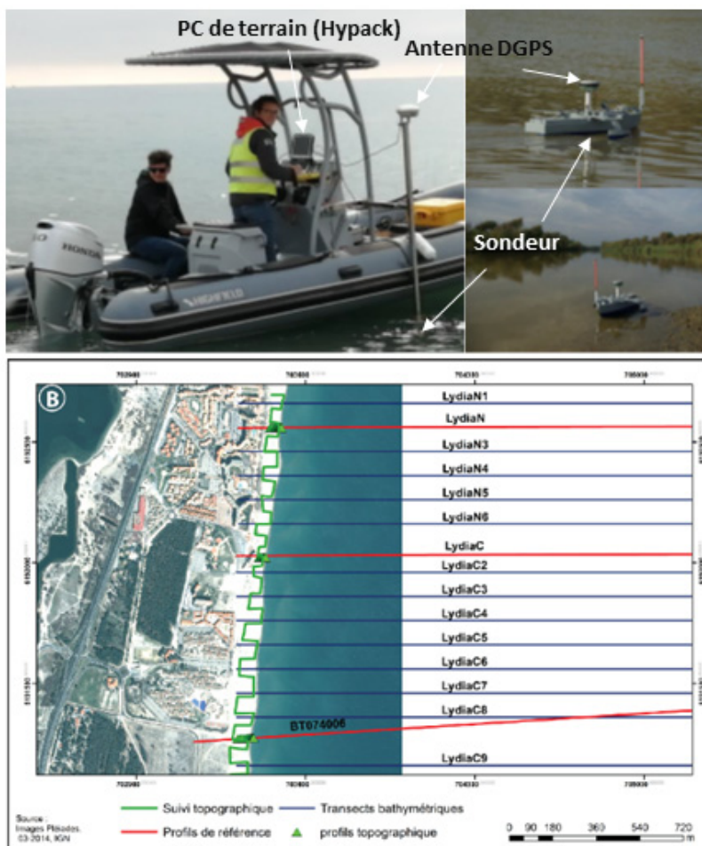
Illustration 11 : Modes d'acquisition des données bathymétriques. Acquisitions bathymétriques en mer, en haut à gauche ; Acquisitions bathymétriques dans les embouchures, en haut à droite ; Transects bathymétriques en bas espacés tous les 100 mètres sur les secteurs d'intérêt.
