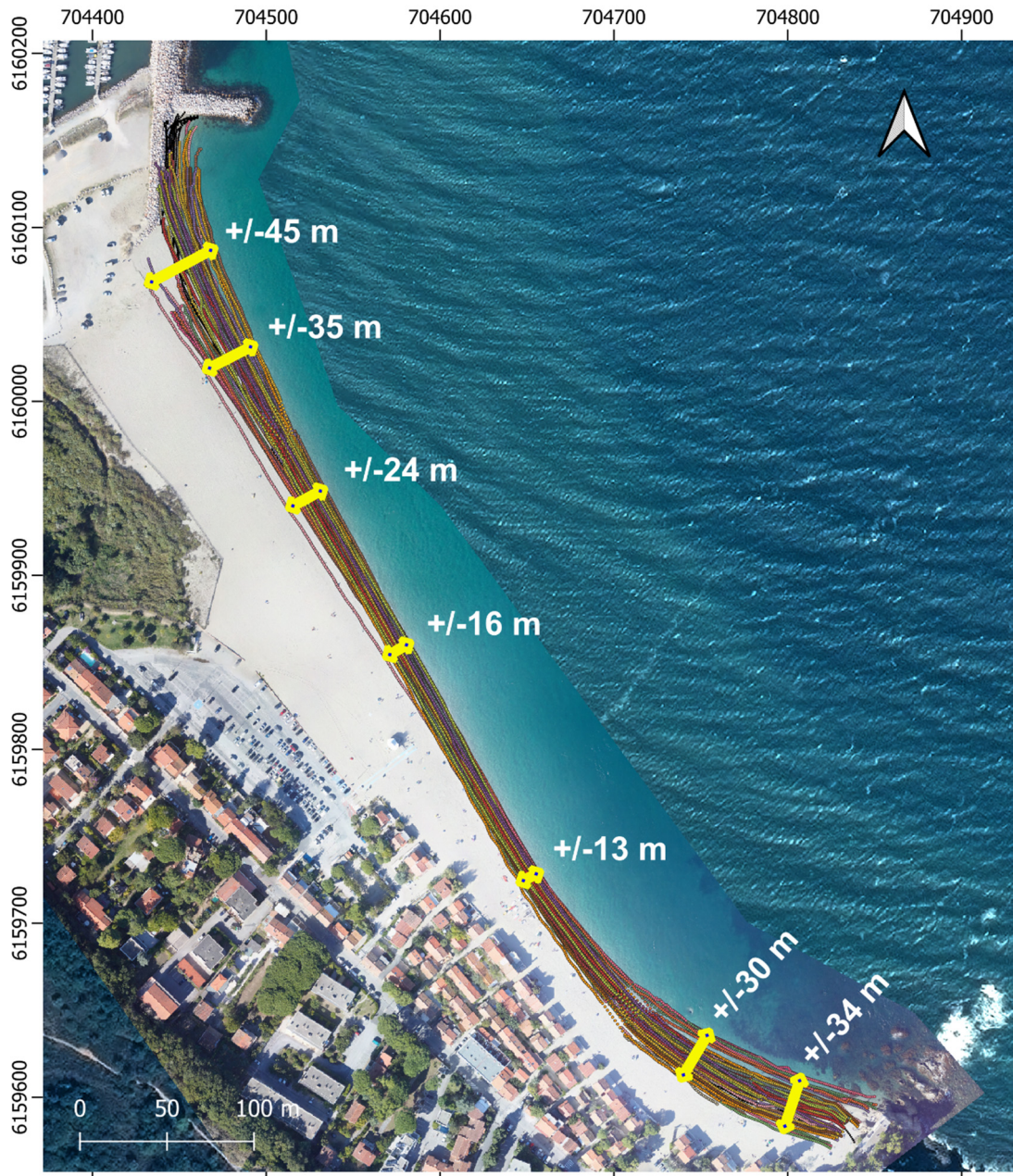
Illustration 65 : Site de la plage du Racou - Carte des traits de côtes extraits des images acquises entre le 1 er janvier 2022 et le 31 décembre 2022 et amplitudes des évolutions.
