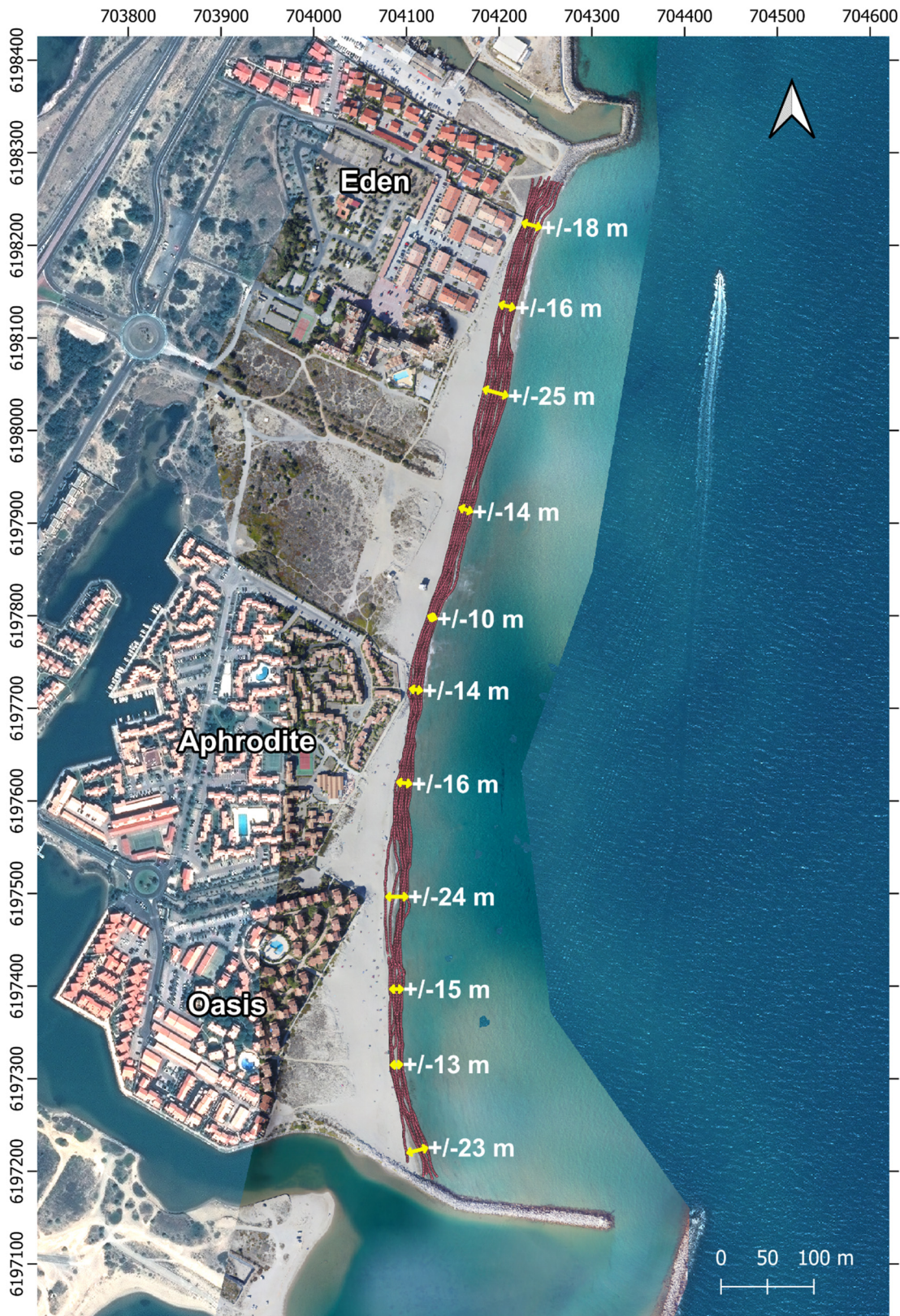
Illustration 223 : Évolution du trait de côte sur le littoral du secteur du village naturistes de Leucate par suivi vidéo haute fréquence. Les flèches jaunes et valeurs indiquent l'amplitude des mouvements sur la période de janvier à décembre 2022.
