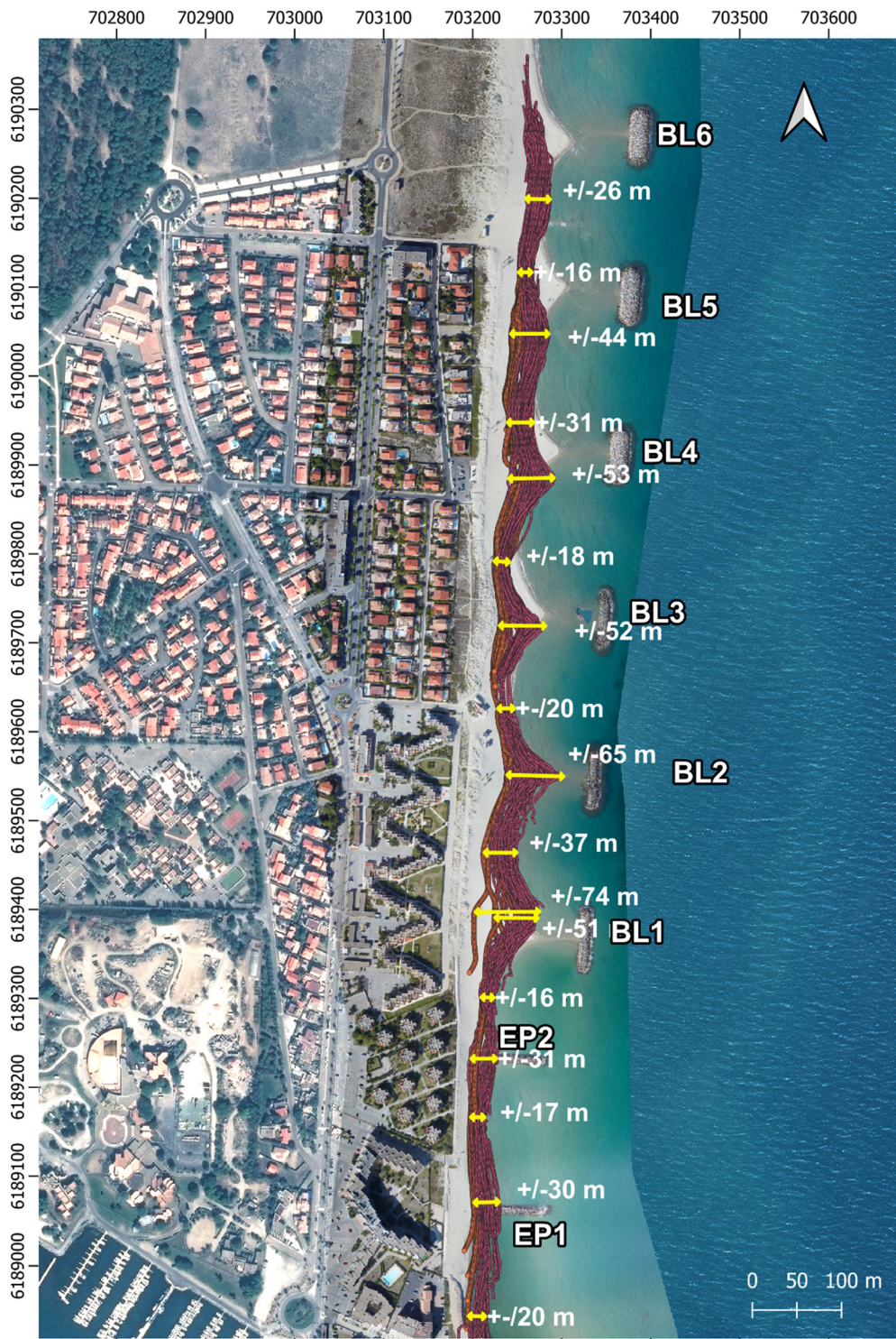
Illustration 198 : Évolution du trait de côte sur le littoral du secteur de Port Barcarès Nord par suivi vidéo haute fréquence. Les flèches jaune et valeurs indiquent l'amplitude des mouvements de janvier à décembre 2022.
