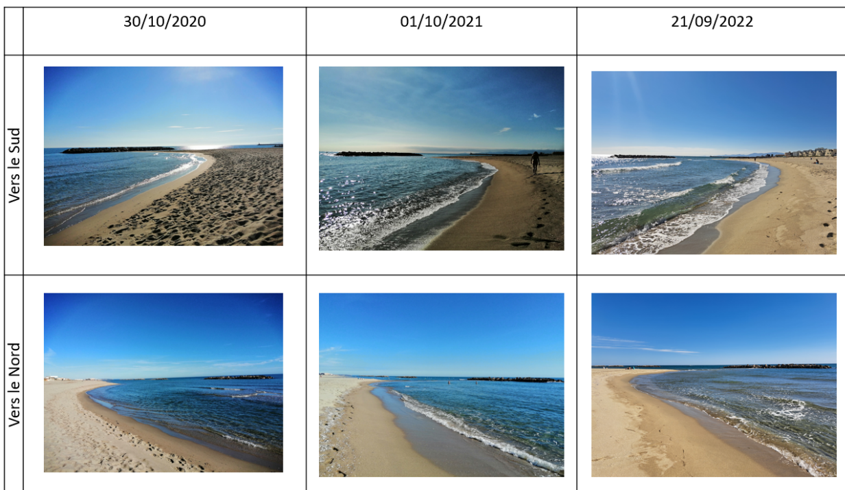
Illustration 190 : Morphologie de la plage, entre les 2 premiers brise-lames entre 2020 et 2022
