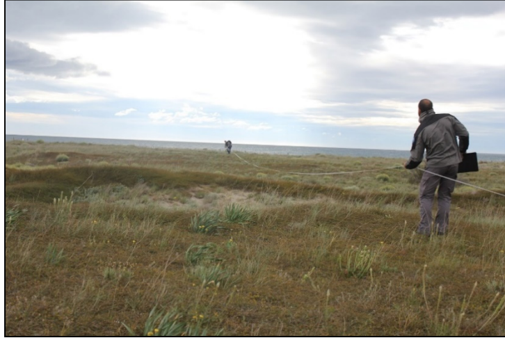
Illustration 22 : Dispositif mis en place pour les levés le long des transects.
