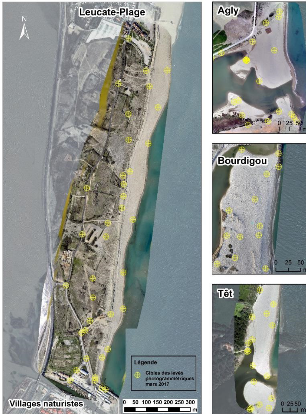
Illustration 10 : Exemple du positionnement des cibles pour les levés photogrammétriques.
